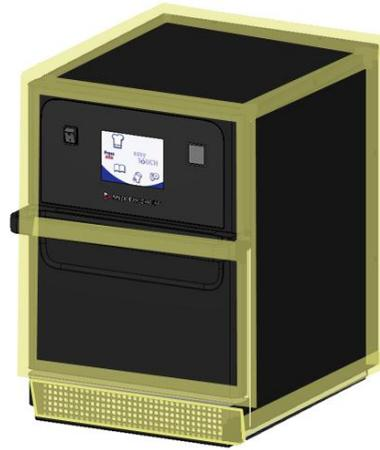
3. قم بضبط جهاز قياس التسريب على المقياس/النطاق الملائم. قم بتحريك مجس مقياس المسح على جميع مناطق التوصيل والتهوية الخاصة بالعمل بما في ذلك المناطق المحددة باللون الأصفر.
