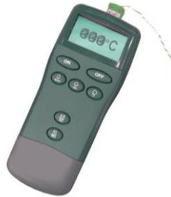
4. أدخل القيمة من الجهاز القارئ لدرجة الحرارة باستخدام لوحة المفاتيح واختر "موافق" (OK) لمعايرة لوحة المرحلات الذكية مع مجس درجة الحرارة (المزوجة الحرارية).
