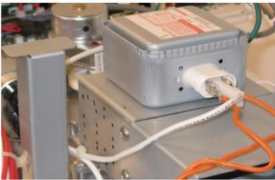
3. باستخدام المقياس الرقمي متعدد القياس، اختبر مقاومة العزل بين:
